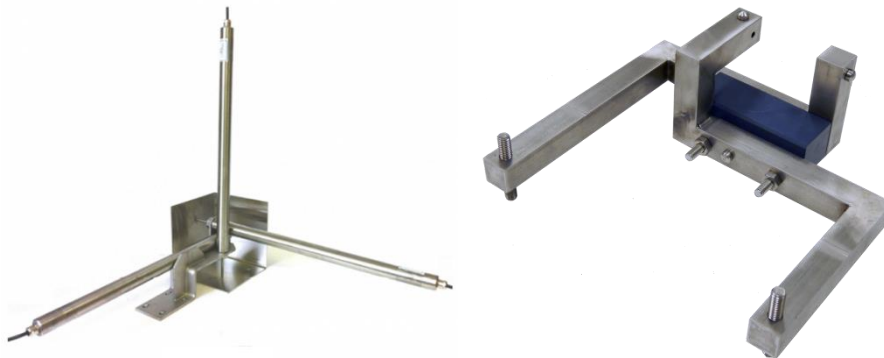
ნახაზი 6-5 : ბზარმზომის ნიმუში : მარჯვნივ ავტომატური ტიპის ბზარმზომი (სამი ერთგანზომილებიანი ავტომატური ტიპის ბზარმზომის მოწყობა); მარჯვნივ – მექანიკური ტიპის (Vinchon) ბზარმზომი.
